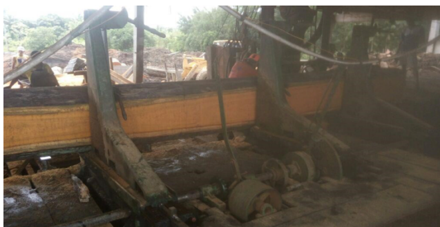
Figura 10 - Processamento de tora por serra fita (MOTA, 2018).
