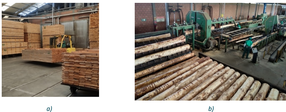
Figura 14 - Transportes internos da serraria: a) empilhadeira; b) correntes transportadoras.
