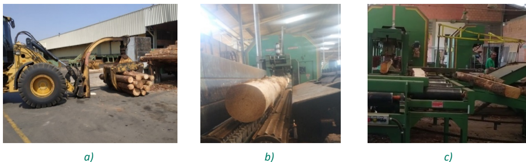
Figura 13 - Processamento da madeira serrada: a) alimentação de toras na linha; b) tora após descascamento; c) desdobro primário da tora.
