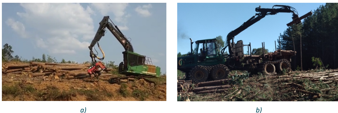
Figura 12 - Máquinas utilizadas nas colheitas de florestas plantadas: a) Harvester; b) Forwarder.
