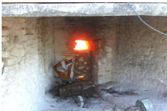
Figura 3 – Forno vertical de Alvenaria (barranco) (fonte: GURGEL e PINTO FILHO, 2012).
