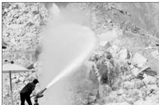
Figura 11 - Lavra de areia em cava seca com desmonte hidráulico. Fonte: (CETEM, 2012).
