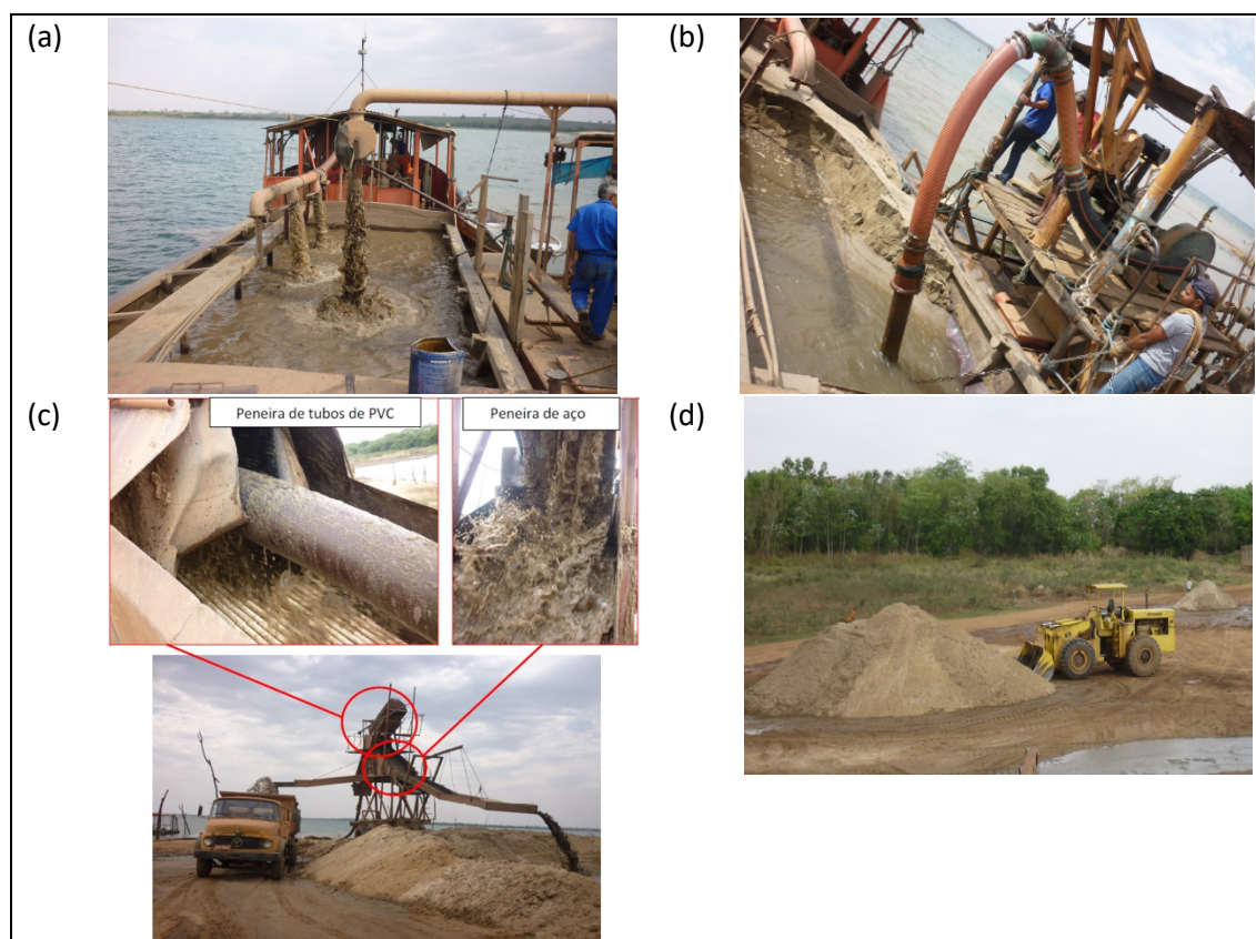
Figura 9 - Etapas da produção da areia processada em leito de rio: (a) sucção de areia do leito do rio através da draga fixa (jato de areia maior, à direita) e da draga móvel (dois jatos de areia menores, à esquerda); (b) bombeamento da areia até as peneiras; (c) peneiramento e classificação da areia, que é separada em fina (carregada no caminhão à esquerda) e grossa (despejada no monte à direita); (d) empilhamento e revolvimento do material para secagem. Fonte: Adaptado de Souza (2012).
