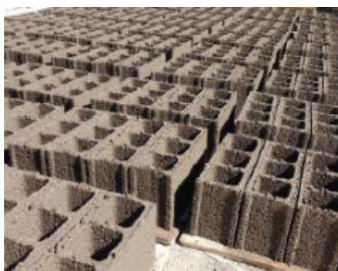
(e) Fabricação de blocos de vedação de concreto.
