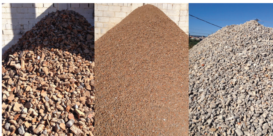
Figura 1 – Agregados reciclados mistos (duas primeiras fotos) e cinza com materiais cimentícios (última foto). Fonte: Pesquisa Setorial ABRECON 2020 (ANGULO; OLIVEIRA; MACHADO, 2021)
