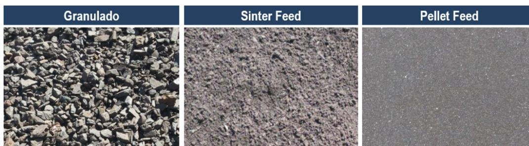
Figura 3. Apresentação do minério de ferro após beneficiamento. Fonte: CSN Mineração<sup>2</sup>
